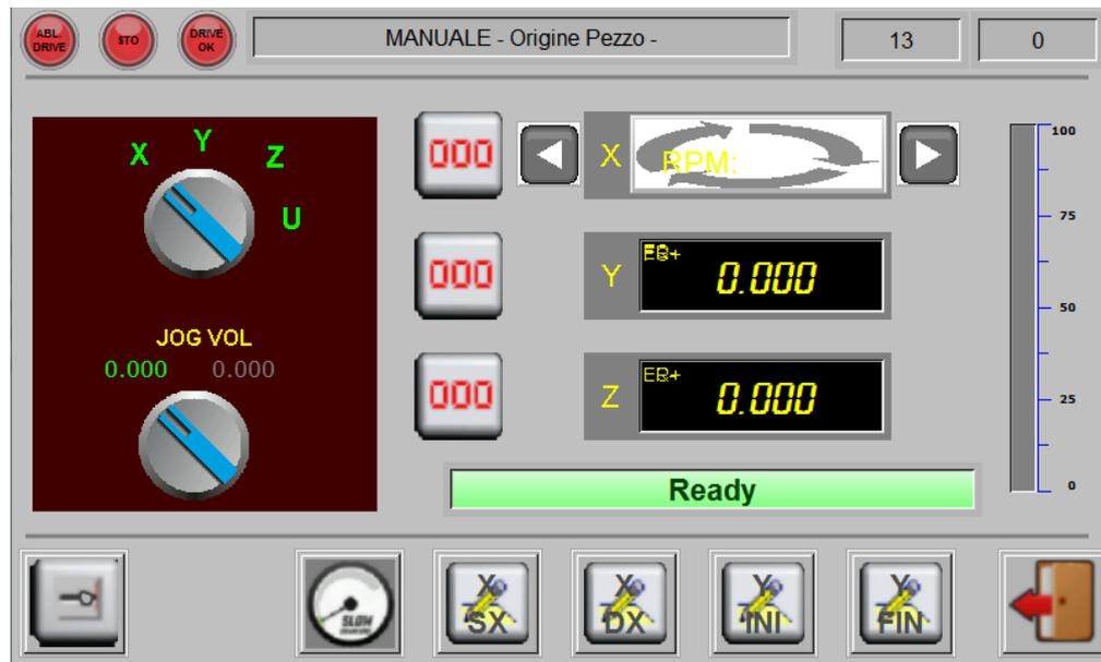
Nella parte superiore dello schermo viene segnalato l'origine con cui il controllo sta visualizzando gli assi per facilitare l'operatore.
