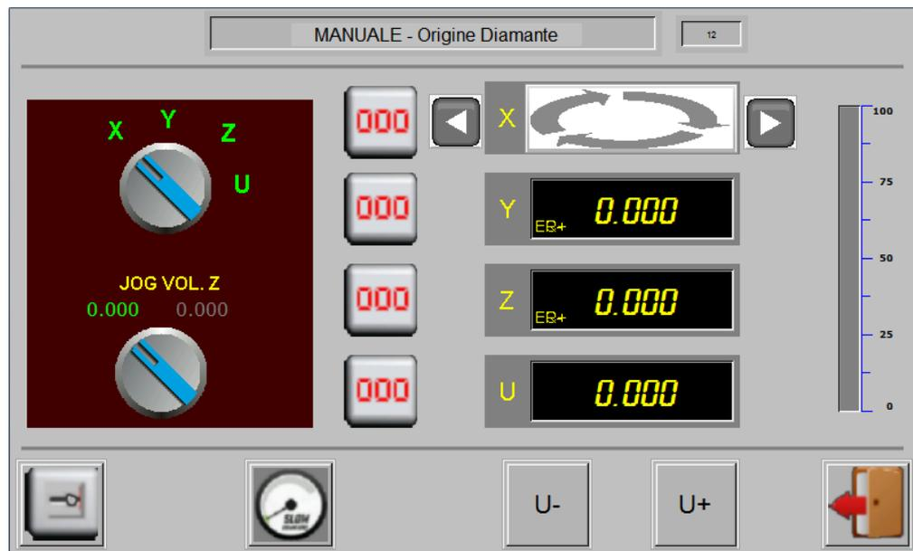
Entrando in manuale tramite la pagina di Edit dati diamantatura, avremo una pagina simile alla precedente, ma con la possibilità di muovere anche l'asse U (Diamantatore Passo Passo) tramite i tasti in fondo alla schermata U+ e U-.
